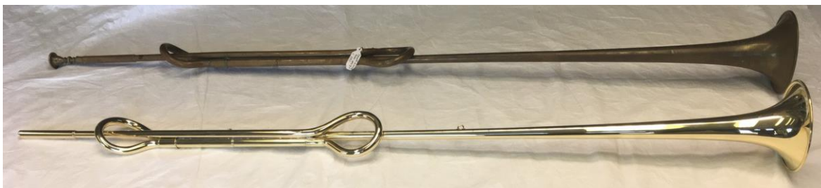
Figure 1: Photographie de la trompette E.0925 originale (haut) et de la copie fabriquée par J. Wiss (bas).
